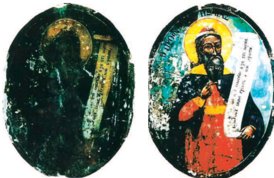
ΕΙΚΟΝΑ 1.12 Συντήρηση εικόνας του 17ου αιώνα με τη χρήση λέιζερ. Αριστερά φαίνεται η εικόνα πριν την παρέμβαση με λέιζερ, και δεξιά, μετά την παρέμβαση.
