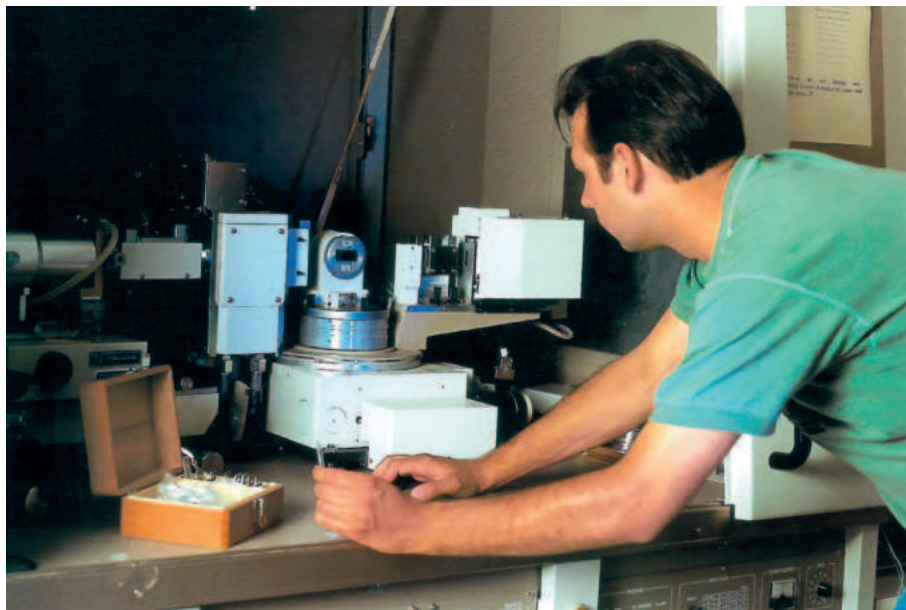
ΕΙΚΟΝΑ 1.11 Διάταξη Περίθλασης Ακτίνων Χ με γεννήτρια Περιστρεφόμενης Ανόδου της Ομάδας Πολυμερών του ΙΗΔΛ, τη δεκαετία του 1990.
