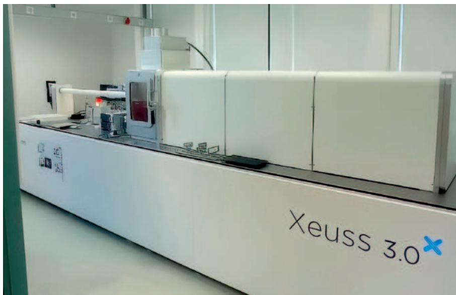
ΕΙΚΟΝΑ 1.24 Η υποδομή του Εργαστηρίου Υβριδικών Νανοδομών του Τομέα Χαλαρής Ύλης εξακολουθεί να μεγαλώνει. Η διάταξη σκέδασης ακτίνων Χ σε μικρές και μεγάλες γωνίες, XENOCs Xeuss 3.0 SAXS / WAXS αποκτήθηκε το 2022 και θα αυξήσει σημαντικά τις δυνατότητες έρευνας και χαρακτηρισμού υλικών του ΙΗΔΛ.
